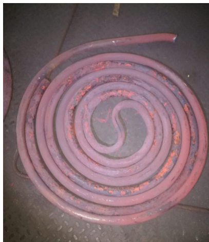
Рисунок 2 – Наружная поверхность труб змеевиков
